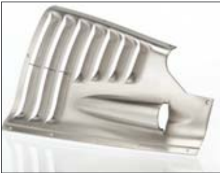
Stereolithographie-Bauteil mit Metalcoating ersetzt Karbonlaminat-Modelle im Windkanal
